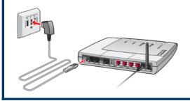
Schließen Sie die FRITZ!Box mit dem DSL-Kabel (grau) an.
